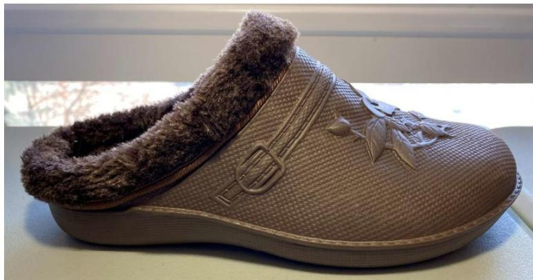
[65] M. Chen a déclaré que la chaussure est fabriquée en infusant ou en injectant du CAV/E dans un moule afin de fabriquer la coquille de la chaussure, puis la doublure en fourrure est collée à l'intérieur de la coquille, tandis que le col est cousu à la coquille, par l'extérieur. Les
